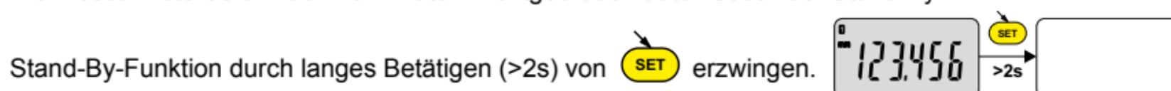
Im Stand-By-Modus wird der Referenzwert vom Sensor (SIS Modus) beibehalten und das Instrument startet automatisch mit einer Bewegung des Messeinsatzes sowie über RS, oder eine Taste drücken.
